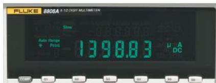
Il Fluke 8808A ha due gamme di corrente a bassa impedenza per la misura delle correnti di dispersione
