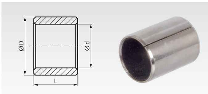
Gleitlager-Buchse aus Stahlblech mit multiporöser Bronzeschicht und Gleitschicht aus PTFE-Blei-Gemisch. Besonders geeignet für Trockenlauf, hohe Belastung, extreme Temperaturen.
