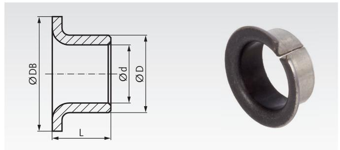
Gleitlager-Bundbuchse aus Stahlblech mit multiporöser Bronzeschicht und Gleitschicht aus PTFE-Blei-Gemisch. Besonders geeignet für Trockenlauf, hohe Belastung, extreme Temperaturen.
