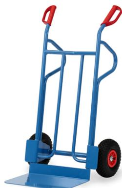
Ensemble mécano-soudé en tube et tôle d'acier, revêtement époxy bleu RAL 5007. Poignées de sécurité en plastique dur avec arceaux de sécurité. Bavette en tôle d'acier à boulonner et remplaçable. Roues gonflables, moyeu à roulement à rouleaux. Livré avec bavette démontée.
