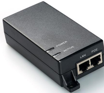
**10/100/1000Mbps, Stromversorgung: 4/5(+), 7/8(-), Ausgang max. 48V 15,4 W**
