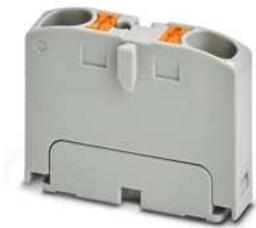
Verteilerblock, Grundklemme, Nennspannung: 800 V, Nennstrom: 32 A, Anschlussart: Push-in-Anschluss, Bemessungsquerschnitt: 4 mm<sup>2</sup>, Querschnitt: 0,2 mm<sup>2</sup> - 6 mm<sup>2</sup>, Montageart: aufrasten auf Tragschienenadapter, Direktmontage mit Flansch, Fliegend, Farbe: grau
