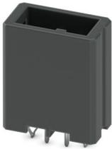
Leiterplatten-Grundleiste, Farbe: schwarz, Nennstrom: 8 A, Bemessungsspannung (III/2): 160 V, Kontaktoberfläche: Zinn, Kontaktart: Stift, Anzahl der Reihen: 1, Polzahl: 2, Artikelfamilie: D31H 2,2/..-V, Rastermaß: 3,81 mm, Montage: Wellenlöten, Pin-Layout: Lineares Pinning, Pinlänge [P]: 3,8 mm, Anzahl der Lötpins pro Potenzial: 1, Stecksystem: CONNEXIS D, Ausrichtung Steckgesicht: Standard, Verriegelung: Rastverriegelung, Befestigungsart: Rastnase, Verpackungsart: verpackt im Karton
