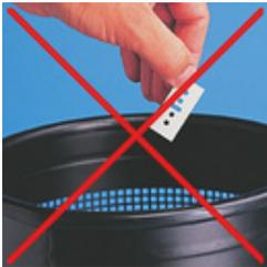
Stumpfe Klingen regelmäßig durch scharfe ersetzen, sonst müssen Sie bei jedem Schnitt durch Druck die Schneidkraft erhöhen, um durch das Material zu kommen. Damit erhöhen Sie aber auch die Ausprallwucht für Unfälle!
