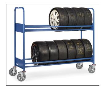
Construction en tube d'acier renforcé, revêtement époxy bleu RAL 5007. Supports de pneumatiques supérieur réglable au pas de 75 mm avec ridelle en tôle d'acier. Convient pour une utilisation plus intensive comme par exemple dans les box des écuries de voitures de courses. 4 roues pivotantes à bandage caoutchouc élastique bleu gris non traçant, moyeu à roulement à billes. 2 roues avec freins conformément à la Norme Européenne EN 1757-3 (Sécurité des chariots de manutention).
