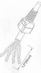
2 Das Kabel in die Knickschutzhülle einführen. Den Kabelmantel ca. 30mm abisolieren, dass Schirmgeflecht und den Beidraht sorgfältig zurückbiegen.
