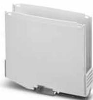
Tragschienengehäuse, Gehäuseunterteil mit Metallfußriegel, Etage 1: mit Lüftungsschlitzen, Breite: 25 mm, Höhe: 122,5 mm, Tiefe: 108,35 mm, Farbe: lichtgrau (7035), Querverbindung: Tragschienen-Busverbinder (optional), Polzahl Querverbinder: 8
