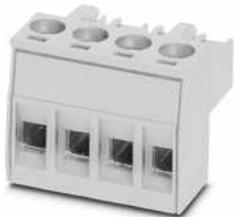
Leiterplattenstecker, Nennquerschnitt: 2,5 mm<sup>2</sup>, Farbe: lichtgrau, Nennstrom: 16 A, Bemessungsspannung (III/2): 320 V, Kontaktoberfläche: Zinn, Kontaktart: Buchse (female), Anzahl der Reihen: 1, Polzahl: 4, Artikelfamilie: MSTBT 2,5 HC/..-STP, Rastermaß: 5 mm, Anschlussart: Schraubanschluss mit Zughülse, Anschlussrichtung Leiter/Platine: 0 °, Rasthaken: - Rasthaken, Stecksystem: COMBICON MSTB 2,5 HC, Verriegelung: ohne, Befestigungsart: ohne
