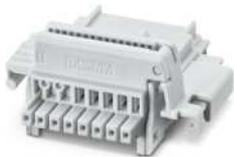
Tragschienen-Busverbinder, Farbe: lichtgrau, Nennstrom: 6 A, 4 A (parallele Kontakte) (serielle Kontakte), Bemessungsspannung (III/2): 32 V, Polzahl: 8, Rastermaß: 2,54 mm, Montage: Tragschienenmontage, Verriegelung: ohne, Befestigungsart: ohne, Verpackungsart: verpackt im Karton, Artikel mit vergoldeten Kontakten, Busstecker zur Verbindung mit Elektronikgehäusen, 4 Parallelkontakte/4 serielle Kontakte
