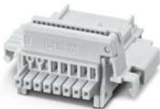
Tragschienen-Busverbinder, Farbe: lichtgrau, Nennstrom: 6 A, 4 A (parallele Kontakte) (serielle Kontakte), Bemessungsspannung (III/2): 32 V, Polzahl: 8, Rastermaß: 2,54 mm, Montage: Tragschienenmontage, Verriegelung: ohne, Befestigungsart: ohne, Verpackungsart: verpackt im Karton, Artikel mit vergoldeten Kontakten, Busstecker zur Verbindung mit Elektronikgehäusen, 7 Parallelkontakte/1 serieller Kontakte
