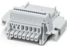
Tragschienen-Busverbinder, Farbe: lichtgrau, Nennstrom: 6 A, 4 A (parallele Kontakte) (serielle Kontakte), Bemessungsspannung (III/2): 32 V, Polzahl: 8, Rastermaß: 2,54 mm, Montage: Tragschienenmontage, Verriegelung: ohne, Befestigungsart: ohne, Verpackungsart: verpackt im Karton, Artikel mit vergoldeten Kontakten, Busstecker zur Verbindung mit Elektronikgehäusen, 6 Parallelkontakte/2 serielle Kontakte
