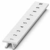
Zackband, Streifen, weiß, beschriftet, beschriftbar mit: CMS-P1-PLOTTER, längs bedruckt: fortlaufende Zahlen 1 ... 10, 11 ... 20 usw. bis 491 ... 500, Montageart: verrasten, für Klemmenbreite: 6,2 mm, Schriftfeldgröße: 6,15 x 10,5 mm, Anzahl der Einzelschilder: 10
