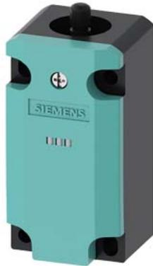
Basisschalter für Positionsschalter 3SE51 Metallgehäuse 40 mm nach DIN EN 50041 Geräteanschluss 1x (M20 x 1,5) mit 2 LEDs, gelb/grün DC 24 V 1S/2Ö Sprungkontakte ohne Antriebskopf
