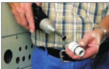
**DURCHFÜHREN** PLIO-SPEED mit der Montagezange durch das Durchgangsgloch schieben und pressen.
