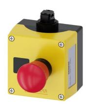
AS-Interface-Gehäuse für Befehlsgeräte, 22 mm, rund, Gehäusematerial Kunststoff, Gehäuseoberteil gelb, 1 Befehlsstelle Kunststoff, Vertiefung für Schild, A=NOT-HALT-Pilzdrucktaster rot, 40 mm, drehentriegelt, 1Ö, 1Ö, Federzuganschluss, Bodenbefestigung, Durchdringungstechnik oben, Schild beigelegt
