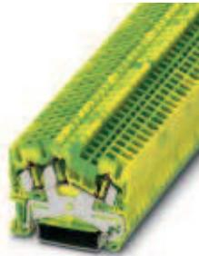
Schutzleiter-Reihenklemme, Anschlussart: Zugfederanschluss, Querschnitt: 0,08 mm<sup>2</sup> - 4 mm<sup>2</sup>, AWG: 28 - 12, Breite: 5,2 mm, Farbe: grün-gelb, Montageart: NS 35/7,5, NS 35/15
