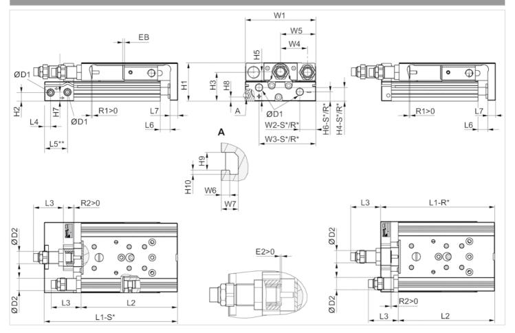
$R^*$ : Bodenausführung mit Luftanschlüssen nur hinten $S^*$ : Bodenausführung mit Luftanschlüssen hinten und seitlich $^{**}$  Ø 8 hat eine andere Bezugsfläche.
