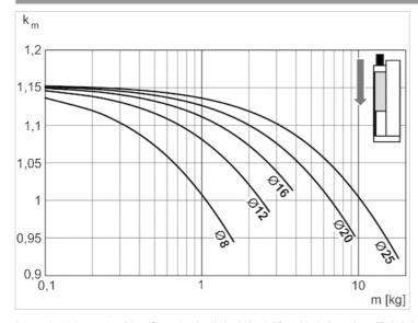
V = s/1000 • t • kmV = Geschwindigkeit [m/s]S = Hub [mm]t = Zeit [s] für einen Hubm = Masse
