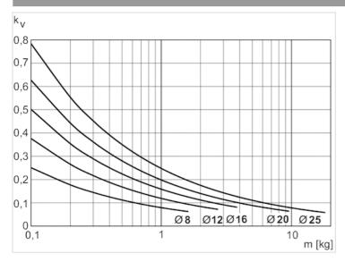
$V = \sqrt{s} \cdot kvV = Geschwindigkeit [m/s]S = Hub [mm]m = Masse$
