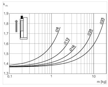
V = s/1000 • t • kmV = Geschwindigkeit [m/s]S = Hub [mm]t = Zeit [s] für einen Hubm = Masse
