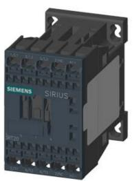
CONTACTOR, AC-3, 3KW/400V, 1NC, DC 125V, 3-POLE, SZ S00 SPRING-LOADED TERMINAL
