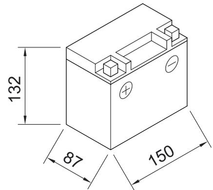
**Technologie** Verschlossene GEL-Batterie | Elektrolyt gelartig gebunden | gefüllt und geladen | absolut wartungsfrei
