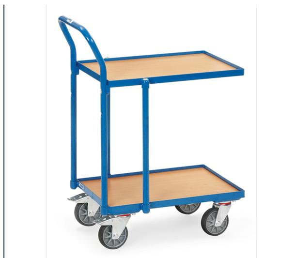
Construction en profilé d'acier, revêtement époxy bleu RAL 5007. Plateaux en mélaminé surface effet hêtre et dossier de poussée pour le transport de bacs Norme Euro. Rebord de 15 mm. 4 roues pivotantes à bandage TPE, moyeu à roulement à billes central. 2 roues avec freins conformément à la Norme EN 1757-3. Compatible pour bacs plastiques 600 x 400 mm.
