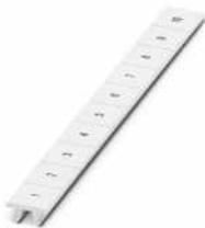
Zackband, Streifen, weiß, beschriftet, beschriftbar mit: CMS-P1-PLOTTER, längs bedruckt: fortlaufende Zahlen 1 ... 10, 11 ... 20 usw. bis 91 ... 100, Montageart: verrasten, für Klemmenbreite: 10,2 mm, Schriftfeldgröße: 10,15 x 10,5 mm, Anzahl der Einzelschilder: 10
