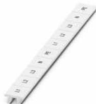
Marker für Klemmen, Streifen, weiß, beschriftet, beschriftbar mit: CMS-P1-PLOTTER, längs: L1, L2, L3, N, PE, L1, L2, L3, N, PE, Montageart: verrasten, für Klemmenbreite: 10,2 mm, Schriftfeldgröße: 10,15 x 10,5 mm, Anzahl der Einzelschilder: 10
