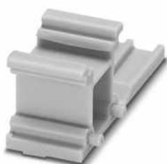
Schildchenadapter, zur Direktmontage oben und Aufnahme der Beschriftung, Länge: 30 mm, Breite: 11 mm, Höhe: 13 mm, Farbe: grau
