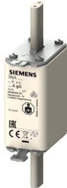
NH-Sicherungseinsatz, NH0, In: 160 A, gG, Un AC: 500 V, Stirnkennmelder, spannungsführende Griffflaschen
