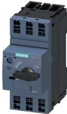
Leistungsschalter Baugröße S00 für den Trafoschutz ohne Phasenausfallschutz A-Auslöser 5,5...8 A N-Auslöser 163 A Federzuganschluss Standardschaltvermögen
