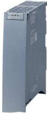
SIMATIC S7-1500, Digitalausgabemodul, DQ 64xDC 24V/0,3A SNK BA, 64 Kanäle in Gruppen zu 16, 2A pro Gruppe bei 60°C, M-schreibend, 35mm breit Kabel und Terminalblöcke als Zubehör separat bestellen
