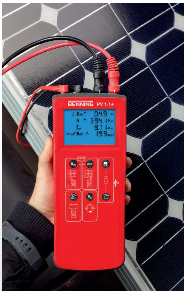
Automessung am PV-Strang (Uoc, Isc, Riso)
