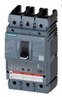
Leistungsschalter 3VA6 UL Frame 150 Schaltvermögenklasse M 35kA @ 480V 3-polig, Anlagenschutz ETU330, LIG, In=150A Überlastschutz Ir=60A...150A Kurzschlussschutz Ii=1,5...10 x In Erdschlussschutz Ig=0,2...1 x In, tg=0,1/0,3s ohne Anschluss
