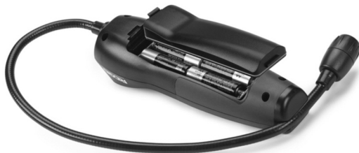
Figura 4 – Extracción de la cubierta del compartimento de las pilas
