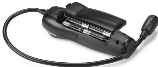
Slika 4 – Odstranjevanje pokrova prostora za baterije
