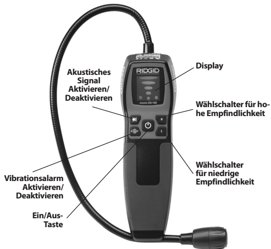
Abbildung 2 – Teile des micro CD-100
