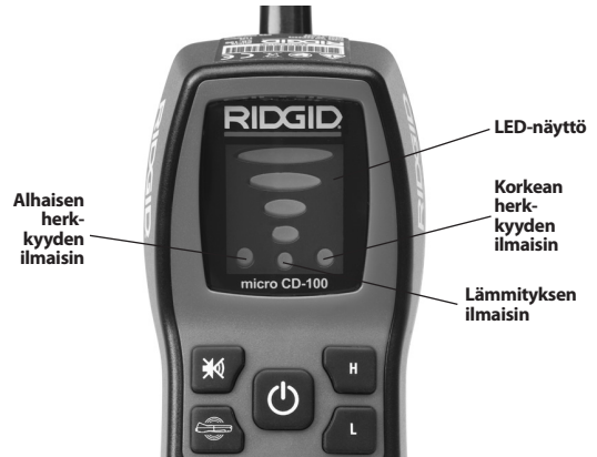
Kuva 3 – micro CD-100:n näyttö
