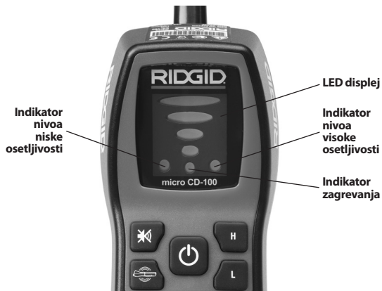
Slika 3 – Displej uređaja micro CD-100
