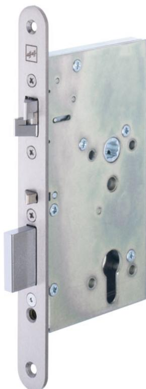
Das Sicherheitsschloss Mikroschalter 409X wird vor allem dort eingesetzt, wo eine versicherungstechnische Verriegelung der Tür durch einen 20 mm Riegelausschluss gewährleistet sein muss. Durch die integrierten Überwachungskontakte können zudem wesentliche Schlosszustände abgefragt werden.
