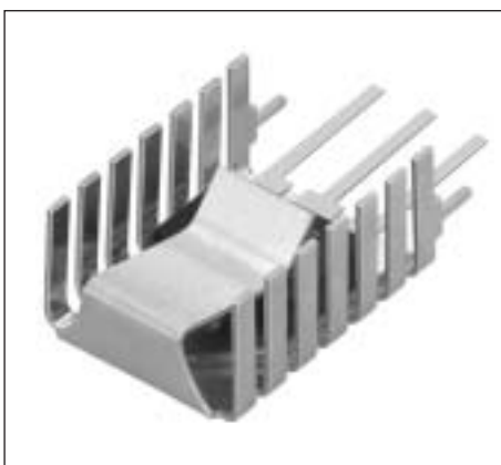
FK 243 MI 247 V 18,4 K/W mit Lötfahne für vertikalen Einbau
