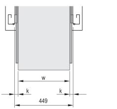
k = Schienenbreite, w = max. Einbaubreite
