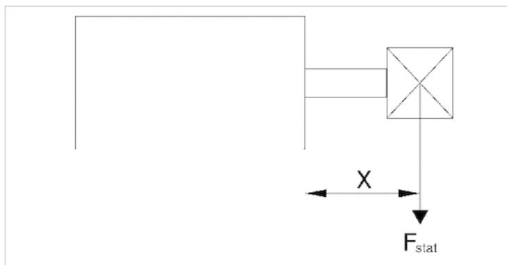
F stat. = statische Seitenkraft X = Abstand zwischen Kraftangriffspunkt und Zylinderdeckel
