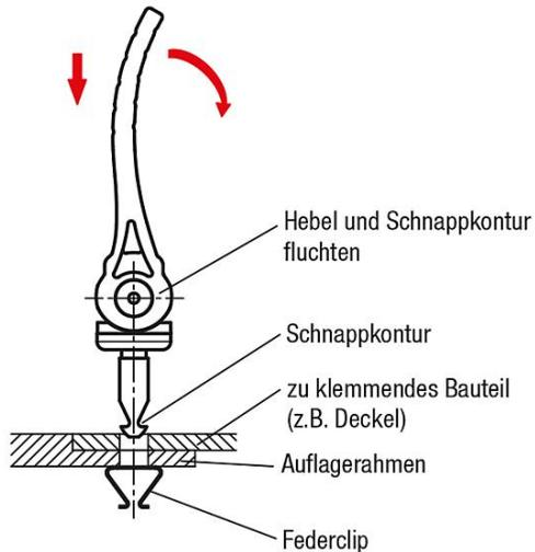
Lösen durch Schwenken und Drehen
