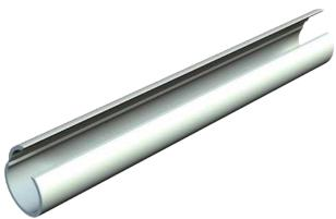
Offenes Rohr Quick-Pipe aus Kunststoff zum Aufputz-Verlegen von Kabeln und Leitungen im Innen-und geschützten Außenbereich. Montage an Wand und Decke mit Quick-Schelle, Star-Quick-Schelle und Multi-Quick-Schelle. Werkzeugloses Verschließen und Öffnen durch Drehen in der Schelle. Einsetzbar im Temperaturbereich von - 25° bis + 60° C.
