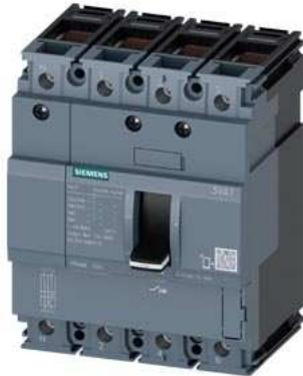
Leistungsschalter 3VA1 IEC Frame 100 Schaltvermögenklasse B Icu=16kA @ 415V 4-polig, Anlagenschutz TM210, FTFM, In=25A Überlastschutz Ir=25A fest eingestellt Kurzschlusschutz Ii=12,8 x In N-Leiter ungeschützt Klemmenanschluss
