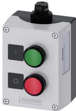
AS-Interface-Gehäuse für Befehlsgeräte, 22 mm, rund, Gehäusematerial Kunststoff, Gehäuseoberteil grau, 2 Befehlsstellen Kunststoff, Vertiefung für Schilder, B=Drucktaster grün, Schild: I, 1S, Federzuganschluss, A=Drucktaster rot, Schild: O, 1Ö, Federzuganschluss, Bodenbefestigung, Durchdringungstechnik oben, Schilder beigelegt
