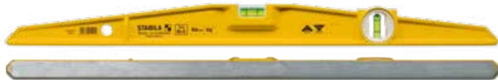
Leichtmetall-Druckgussprofil mit gefräster Messfläche, 1 Vertikal-Libelle und 1 Horizontal-Libelle. **Messgenauigkeit:** in Normallage  $0,029^\circ = 0,5 \text{ mm/m}$ , Überkopfmessung  $0,043^\circ = 0,75 \text{ mm/m}$ .
