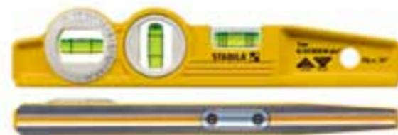
Leichtmetall-Druckgussprofil mit gefräster Messfläche, 1 Vertikal-Libelle und 1 Horizontal-Libelle, drehbarer  $360^\circ$ -Libelle und 1 Seltenerd-Magnet. **Messgenauigkeit:** in Normallage  $0,029^\circ = 0,5 \text{ mm/m}$ , Überkopfmessung  $0,043^\circ = 0,75 \text{ mm/m}$ .
