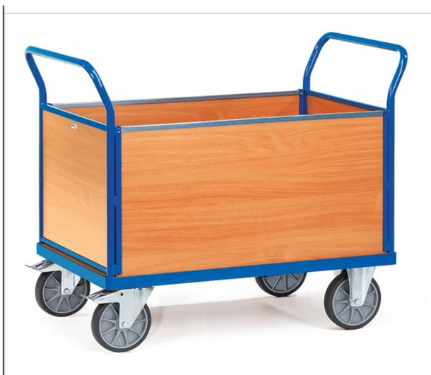
Ensemble mécano-soudé, revêtement époxy bleu RAL 5007, plateau en mélaminé surface effet hêtre avec 4 ridelles en mélaminé, hauteur petits et grands côtés 500 mm, 2 grands côtés amovibles dont un boulonné. 2 roues pivotantes et 2 roues fixes à bandage TPE, moyeu à roulement à billes central. Freins sur roues pivotantes conformément à la Norme 1757-3 (Sécurité des chariots de manutention).
