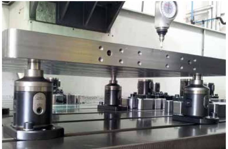
4x Basismodul Doppelspannung auf einer Rasterplatte platziert. Optimale 5-Seiten-Bearbeitung möglich.
