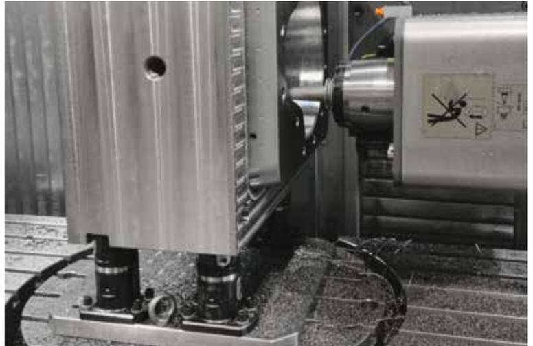
2 Basismodule mit einem Zentrierspanner direkt auf ein Nullpunkt-Spannsystem adaptiert.
