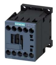
Leistungsschütz, AC-3 12 A, 5,5 kW / 400 V 1 S, AC 400 V, 50 / 60 Hz 3-polig, Baugröße S00 Schraubanschluss
