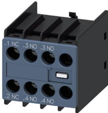
Hilfsschalter frontseitig, 2 S + 1 Ö Strombahn 1 Ö, 1 S, 1 S für 3RH2 und 3RT2 Schraubanschluss .1/.2, .3/.4, .3/.4
