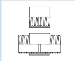
Raccord de tuyau spiralé pour le raccordement, l'allongement ou la réparation de tuyau spiralé, qualité alimentaire
