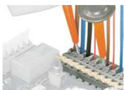
Prüfen mit Prüfspitzen
