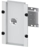
ALPHA NF Einbausatz 1x 3KD Lasttrennschalter Baugr. 1 bis 3 H=400mm, B=250mm für Kabelraum bei Baugr. 1 und 2 für 3- und 4-polige Geräte bei Baugr. 3 nur 3-polig für Türkupplungsdrehantrieb in Feldabdeckung
