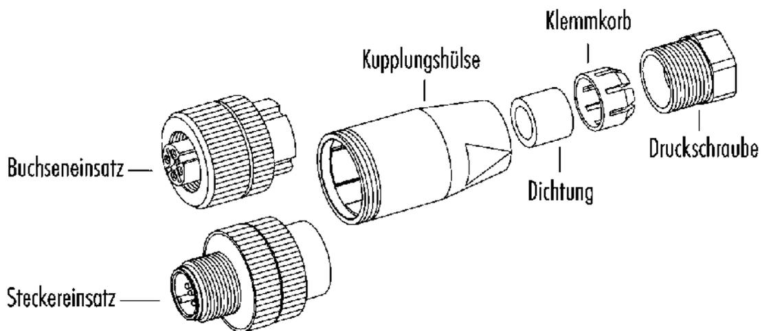
Material der Gewinderinge: Kunststoff, Zink Druckguss, Edelstahl
