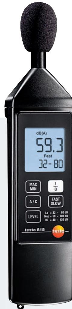
Das testo 815 ist das ideale Gerät zur Beurteilung des Geräuschpegels im Arbeitsalltag. Das Gerät kann für Kontrollmessungen im Klima- oder Heizungsbereich, an Verbrennungsanlagen oder an Arbeitsplätzen eingesetzt werden, aber auch Maschinen- oder Diskothekenlärm lässt sich schnell und präzise beurteilen.
