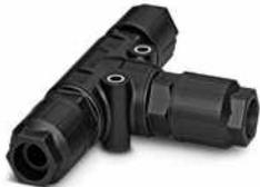
T-Verteiler, QUICKON-Anschluss, Polzahl: 4+PE, 0,5 mm<sup>2</sup> ... 1,5 mm<sup>2</sup>, 690 V, 17,5 A, schwarz, mit drei QUICKON-Muttern, Leitungsaußendurchmesser: 6 mm ... 10 mm
