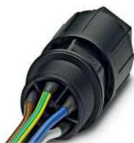
Wanddurchführung, QUICKON-Anschluss, Polzahl: 4+PE, 0,5 mm<sup>2</sup> ... 1,5 mm<sup>2</sup>, 690 V, 17,5 A, schwarz, mit QUICKON-Mutter, Leitungsaußendurchmesser: 6 mm ... 10 mm, Montagegewinde: M25, Einzeladern, 1,5 mm<sup>2</sup>, Leitungslänge: 1 m
