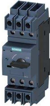
Leistungsschalter Baugröße S00 für den Trafoschutz mit Approbation circuit-breaker UL 489, CSA C22.2 NO.5-02 A-Auslöser 3,2 A N-Auslöser 65 A Schraubanschluss Standardschaltvermögen
