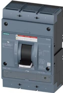
Leistungsschalter 3VA5 UL Frame 800 Max. Kurzschl.-Ausschaltvermögen ohne Schütz 100 kA@480 V 3-polig, Starterschutz TM120M, AM, In=600A ohne Überlastschutz Kurzschlusschutz Ii=8...16 x In beidseitig Kabelanschluss
