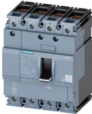
Leistungsschalter 3VA1 IEC Frame 160 Schaltvermögenklasse S Icu=36kA @ 415V 4-polig, Anlagenschutz TM210, FTFM, In=16A Überlastschutz Ir=16A fest eingestellt Kurzschlussschutz Ii=20 x In N-Leiterschutz 100% Klemmenanschluss
