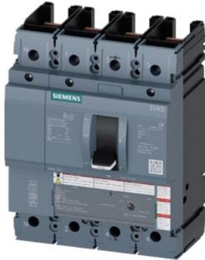
Leistungsschalter 3VA5 UL Frame 250 Schaltvermögenklasse M 35kA @ 480 V 4-polig, Anlagenschutz TM210, FTFM, In=60A Überlastschutz Ir=60A fest eingestellt Kurzschlusschutz Ii=10 x In N-Leiter ungeschützt ohne Anschluss
