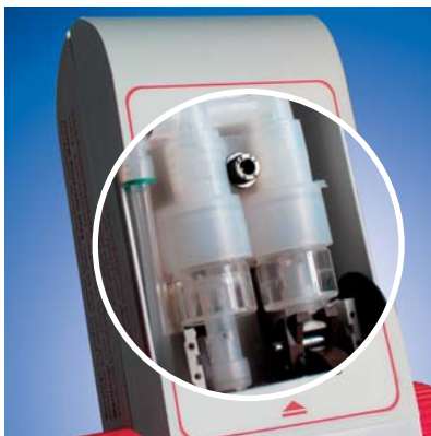
Durch Drehen der beiden Handräder wird das Titriermedium kontinuierlich mit der patentierten 1) Doppelkolben-Pumpe gefördert.
